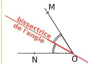
Pour construire la **bissectrice** de l'angle  $\widehat{MON}$ , on commence par le mesurer à l'aide du rapporteur. Il mesure  $58^\circ$ .
